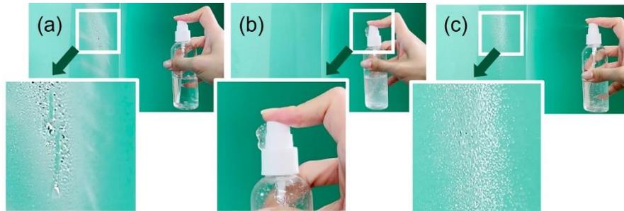
図 1a)水を霧吹きすると液だれし、b)粘度の高い液体は吐出されないが、c)水に CNF を 0.5wt%ほど加えると、霧吹きしても液だれしない液体になる。
