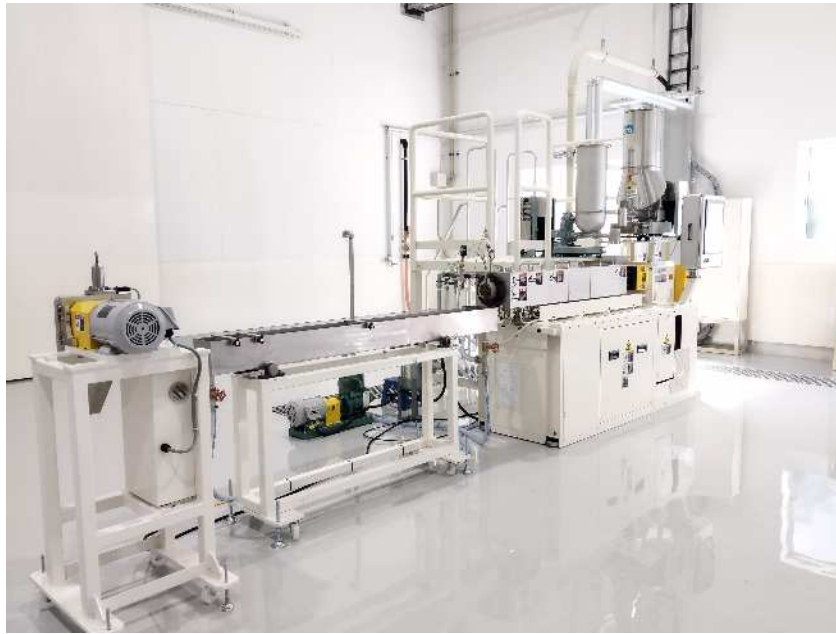
【写真】二軸混練押出機
